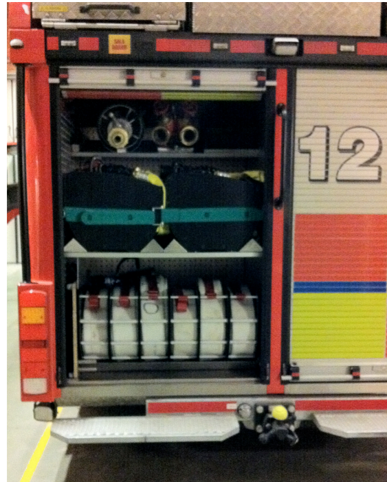
Brandslang i QuickBag slangväskor på insatsbil vid Uppsala Brandförsvär. Ordningen ombord skapar effektiva insatser.
