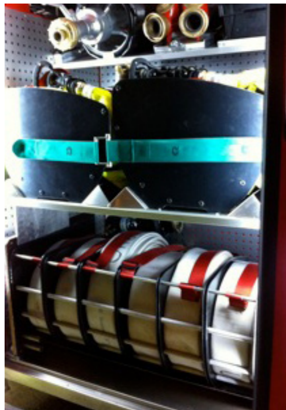
Bilden visar slangutläggning med QuickBag slangväska.
